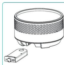
**4** Insérez le boîtier du ventilateur de la batterie dans la base en plastique.
