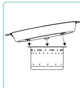
**1** Fissare il bordo superiore della camera con la fibbia nella parte inferiore della base del barbecue.
