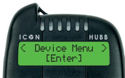
Lorsque «Menu de l'appareil» est affiché, utilisez le bouton OK pour accéder au sous-menu. Allez à «Sensibilité» pour régler la sensibilité de la ligne sur le détecteur
