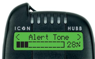
Dans le "menu avancé" aller dans "tonalité alerte" pour ajuster la tonalité des alertes du détecteur.
