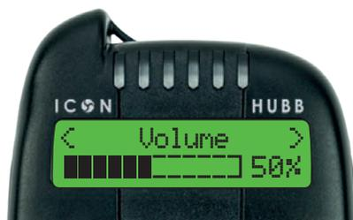
Dans le "menu avancé" aller dans "volume alerte" pour ajuster le volume des alertes du détecteur.
