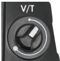
Le cadran V/T (en haut à droite) règle le volume/tonalité des alertes sur le détecteur Vi et (après avoir appuyé sur le bouton de mode).
