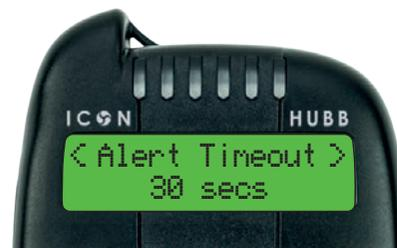
Aller dans «délais alerte» pour ajuster le temps de fonctionnement de la LED sur le détecteur. 60Secondes / 30 secondes / 20 secondes / 10 secondes / 5 secondes.
