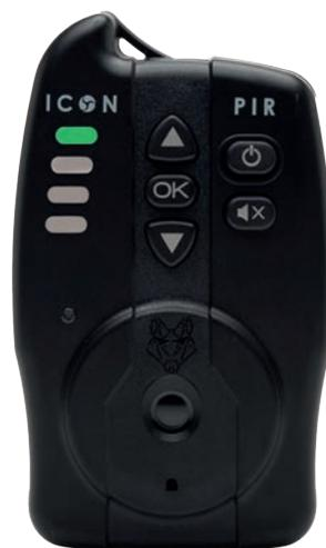
Da inattivo, premi OK per accedere alla modalità di navigazione dei canali, premi due volte il pulsante di accensione per attivare "Opzione dispositivo" del dispositivo associato.
