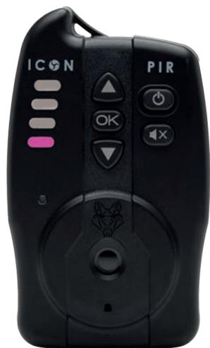
In modalità inattiva, premere OK per accedere alla modalità di navigazione dei canali. L'ultimo canale a ricevere un avviso sarà selezionato per impostazione predefinita e il LED del canale corrispondente lampeggerà nel colore di avviso selezionato. Se il canale non è accoppiato, il LED del canale lampeggerà velocemente in rosso.
