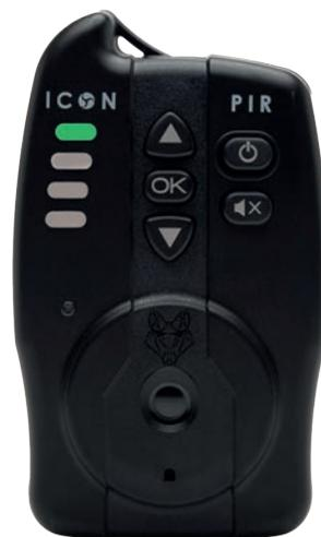
Drücke im Ruhezustand die OK-Taste, um in den Kanalsuchmodus zu gelangen, und drücke zweimal die Ein/Aus-Taste, um die "Geräteoption" des gekoppelten Geräts umzuschalten.
