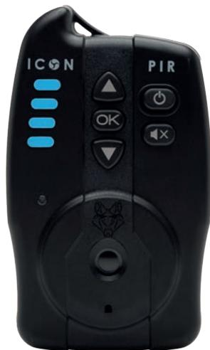
Um den PIR-Sounder auf die Werkseinstellungen zurückzusetzen und alle Benutzerdaten zu löschen, schalten Sie den PIR-Sounder aus und dann wieder ein, während Sie die Stummschalttaste gedrückt halten. Wenn alle Kanal-LEDs blau leuchten, lassen Sie nur die Stummschalttaste los, während Sie die Netztaaste gedrückt halten. Wenn die blauen LEDs blinken und ausgeschaltet sind, können Sie die PIR-Sirene wieder einschalten, indem Sie die Netztaaste gedrückt halten.
