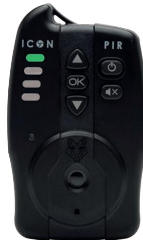
Drücken Sie im Ruhezustand die Taste OK, um den Kanalsuchmodus aufzurufen. Verwenden Sie die Aufwärts- und Abwärts-Tasten, um einen gekoppelten Kanal auszuwählen, der durch eine pulsierende Anzeige-LED angezeigt wird. Halten Sie die Stummschalttaste gedrückt, bis die Anzeige BLAU leuchtet. Loslassen, dann blinkt die Anzeige ROT.
