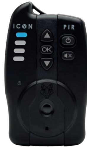
Drücke im Ruhezustand OK, um in den Kanalsuchmodus zu gelangen. Verwende die Aufwärts- und Abwärts-Tasten, um einen ungepaarten Kanal auszuwählen, der durch eine schnell blinkende rote Anzeige gekennzeichnet ist. Halte die Stummschalttaste gedrückt, um die Kopplung zu starten.
