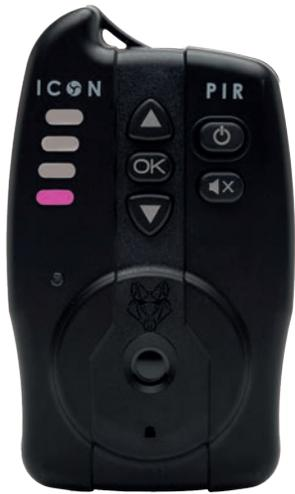
Drücke im Ruhezustand OK, um in den Kanalauswahlmodus zu gelangen. Der letzte Kanal, der einen Alarm erhalten hat, wird standardmäßig ausgewählt, und die entsprechende Kanal-LED pulsiert in der ausgewählten Alarmfarbe. Wenn der Kanal nicht gepaart ist, blinkt die Kanal-LED schnell rot.
