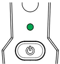
Après la mise sous tension, le PIR commencera une séquence d'armement, avec un clignotement de la LED dans la couleur d'alerte sélectionnée. Le clignotement s'accélère à mesure que la séquence se termine. Cela donne à l'utilisateur environ 15 secondes pour configurer l'appareil et sortir de la zone de détection sans déclencher d'alerte. Une fois la séquence terminée, le PIR commencera la détection.
