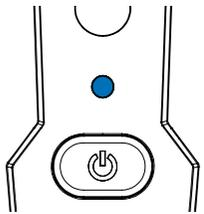
Lorsque le récepteur est prêt pour l'appairage, maintenez enfoncé le bouton d'alimentation pendant 8 secondes. La LED clignotera en bleu pour indiquer que le PIR est prêt pour l'appairage.
